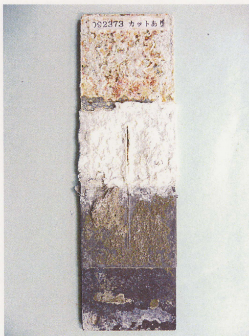
写真6 モルタル破壊後の試験体(カットあり)
